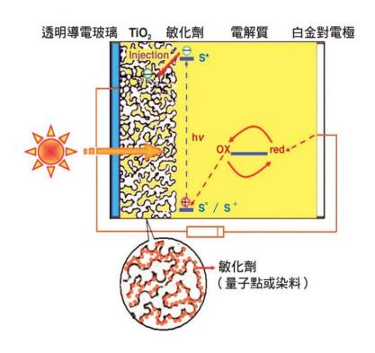
▲染料敏化太陽能電池結構的示意圖
