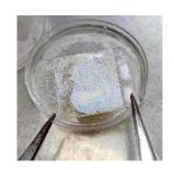
6. 將正極導電面朝上平置於桌面,滴上含有碘 電解質的碘液,如圖 4-2-5。
