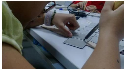
圖 22. 採串聯方式焊接晶片
