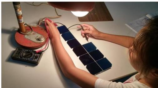
圖 23. 依序測試電流、電壓並記錄
