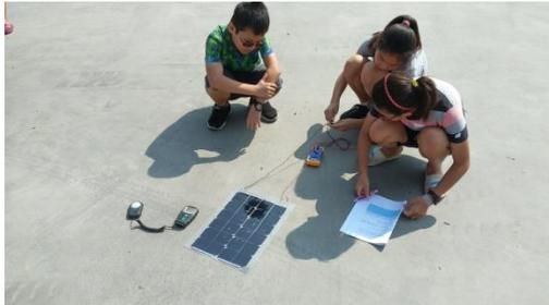
圖 27.發電量與照度的關係測量
