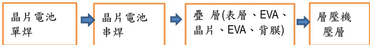
表 6. 自組太陽能模組封裝流程:(疊層使用護貝膜，護貝機做壓層)
