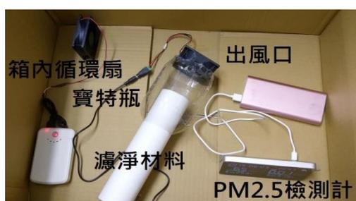
圖 13.紙箱內測試時位置概況
