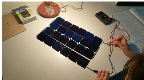
圖 24. 封裝前做最後測試及檢查
