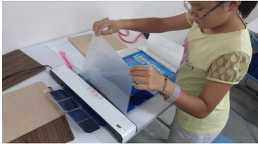
圖 25.使用護貝膜封裝太陽能板
