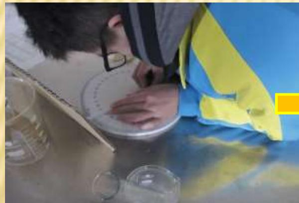
將不同濃度糖水溶液倒進已校正好的壓克力透明半圓形水槽內
