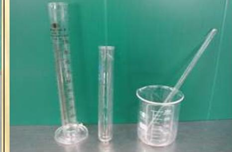
燒杯、量筒、試管、玻璃棒、滴管(圖四)
