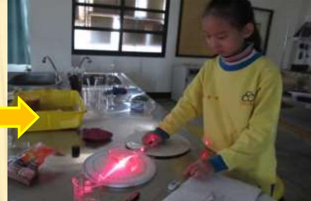
放上壓克力透明半圓形水槽觀察反射光的夾角是否與入射光夾角相同
