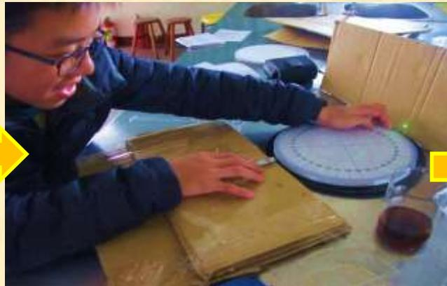
將指定的入射角度對準雷射筆的發射口，雷射光射向圓形角度盤的圓心
