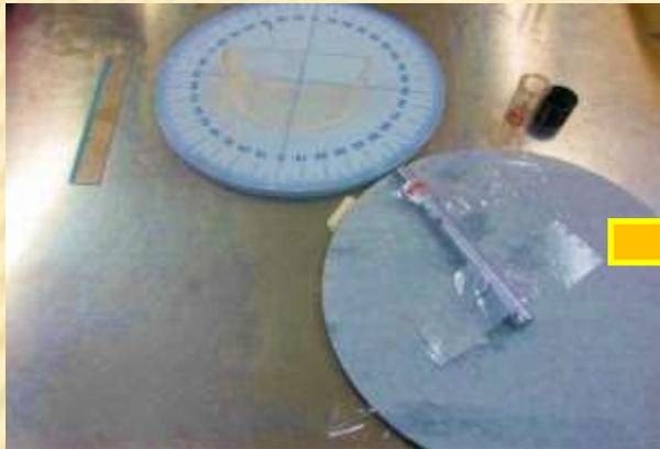
將圓形角度盤與底座分開並將雷射筆以膠帶固定於底座上
