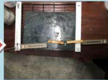
圖 30 固定左側彈簧秤，拉動右側彈簧秤直到晶球破裂。
