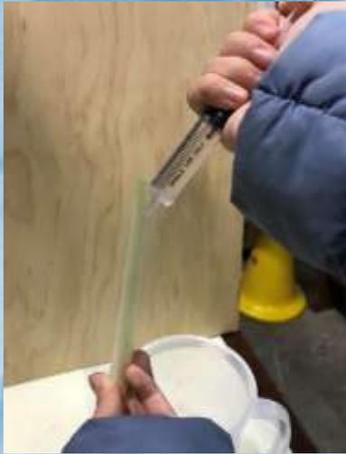
1. 將海藻酸鈉水溶液填入模型中
